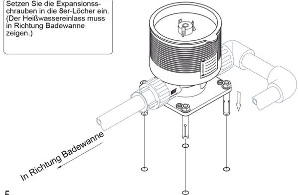
Setzen Sie die Expansionsschrauben in die 8er-Löcher ein. (Der Heißwassereinfluss muss in Richtung Badewanne zeigen.)
