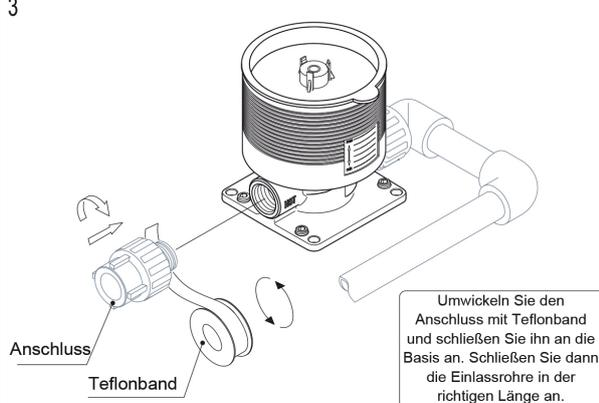
Umwickeln Sie den Anschluss mit Teflonband und schließen Sie ihn an die Basis an. Schließen Sie dann die Einlassrohre in der richtigen Länge an.
