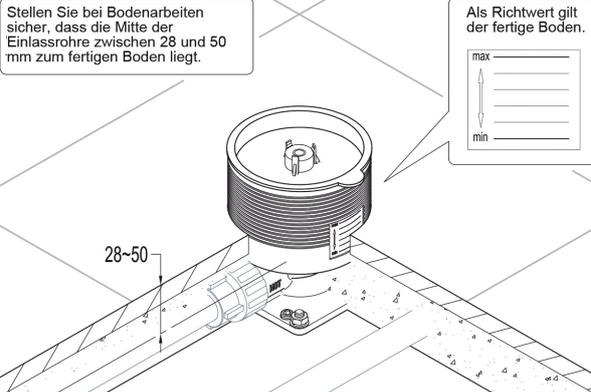
Stellen Sie bei Bodenarbeiten sicher, dass die Mitte der Einlassrohre zwischen 28 und 50 mm zum fertigen Boden liegt.
